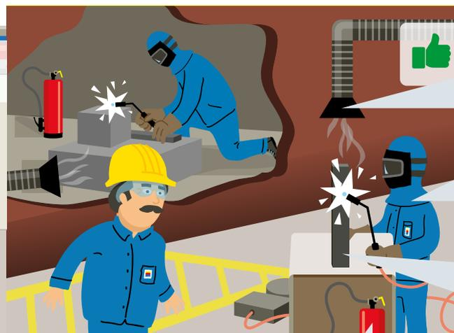
Aspirare i fumi di saldatura all'origine oppure impiegare bruciatori con aspirazione.
