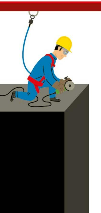
**Quando non sia possibile una protezione collettiva, vanno impiegati dei dispositivi di protezione individuale anticaduta**
